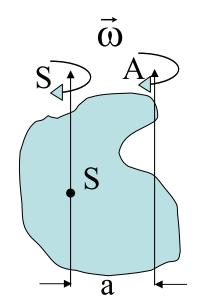
Es gilt für das Trägheitsmoment bei Drehung um die Achse A und um die Achse S (M ist Gesamtmasse)
