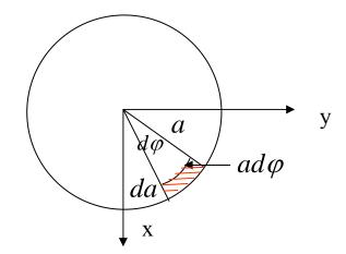
Das rot gestrichelte Flächenelement in der x-y-Ebene hat die Fläche **dA=a dφ da.** Wenn man φ von 0 bis 360° variiert und a von 0 bis R, überdecken die Flächenelemente dA die Zylinder-Basisfläche
